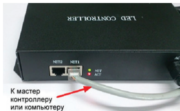
Рис.2. Подключение контроллера HX-801RC к мастер-контроллеру или компьютеру.
